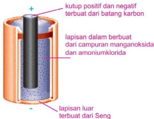
Gambar 9.6 Baterai dan bagian-bagiannya
