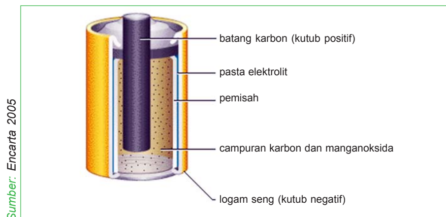
Gambar 6.4 Bagian-bagian batu baterai
