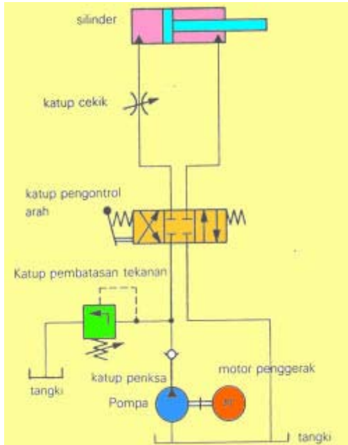
Gambar 3.9 Sistem hidrolik sederhana
