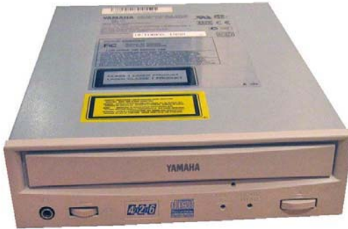
Gambar 3.17. CD-RW Drive, salah satu contoh Optical Disc Drive .
