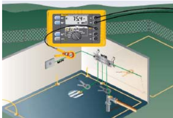
Gambar 5 – 30 Pengukuran tahanan tanah masing-masing pada sistem pentanahan menggunakan pengtesen terpilih
