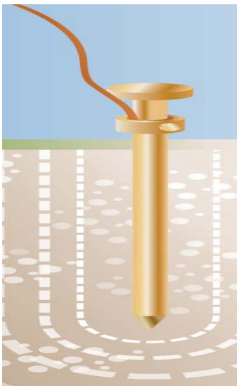
Gambar 5 – 11 Elektroda yang mempunyai pengaruh lapisan
