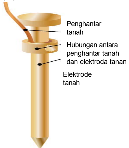
Gambar 5 – 15 Hubungan antara penghantar tanah dan elektroda tanah
