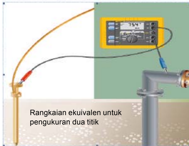
Gambar 5 – 26 Mengukur tahanan tanah dengan dua kutub
