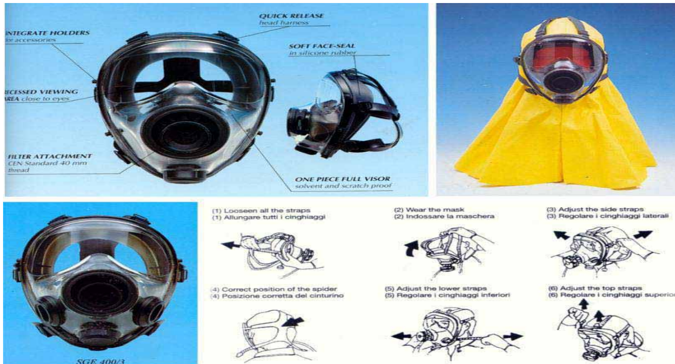
Gambar 8. 21 Bagian-Bagian Respirator dan Cara Pemakaian
