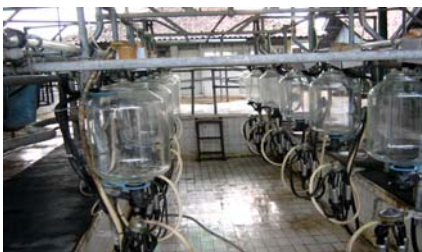
Gambar 118. Mesin Perah Tipe Herringbone dengan Tabung Individu.
