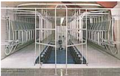
Gambar 117. Mesin Perah Herringbone
