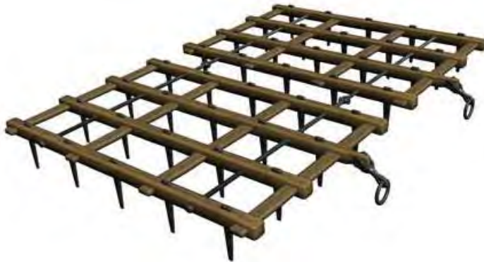
Gambar 25. Garu Sisir Untuk Lahan Kering
