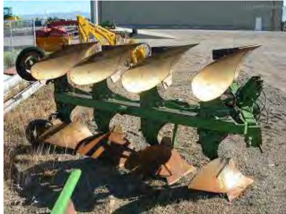
Gambar 18. Bajak Singkal Dua Arah (empat singkal)
