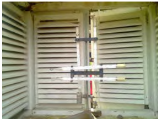
Gambar 90. Psychrometer Bola Basah Dan Bola Kering
