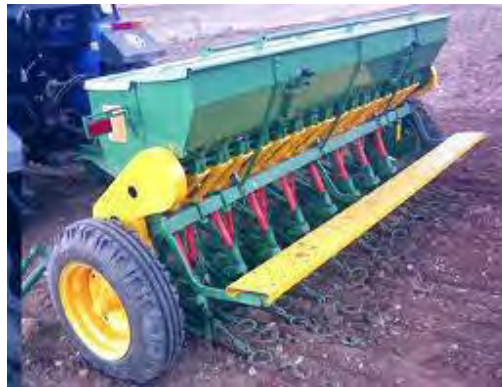
Gambar 29. Alat Penanam Sistem Baris Sempit
