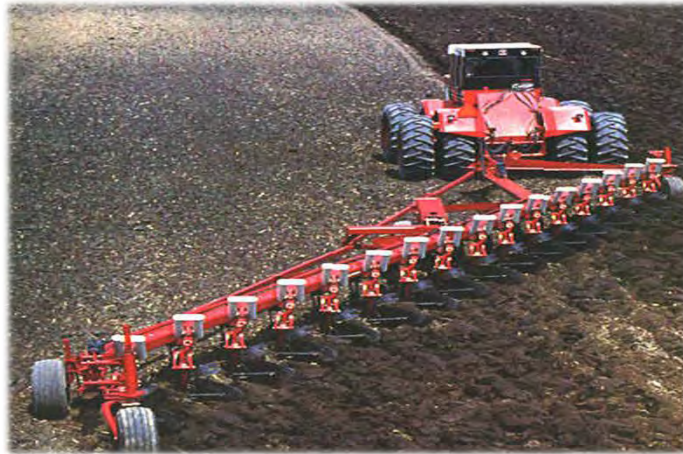
Gambar 19. Bajak singkal ditarik traktor besar (16 singkal)
