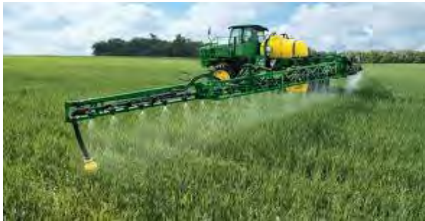
Gambar 33. Alat penyebar pupuk cair dan gas
