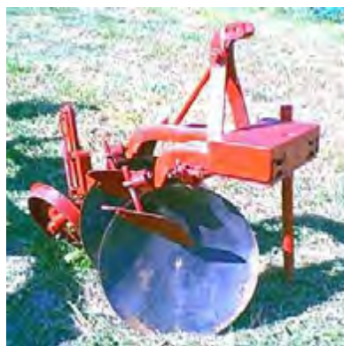
Gambar 20. Bajak Piring (Dua Piringan)
