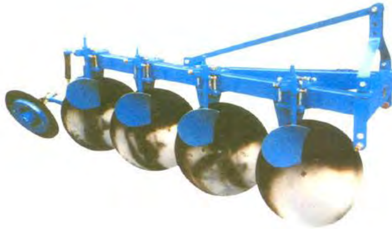
Gambar 21. Bajak Piring (Empat Piringan)
