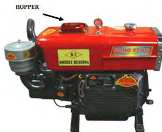
Gambar 112. Motor Diesel dengan pendingin sistem hopper
