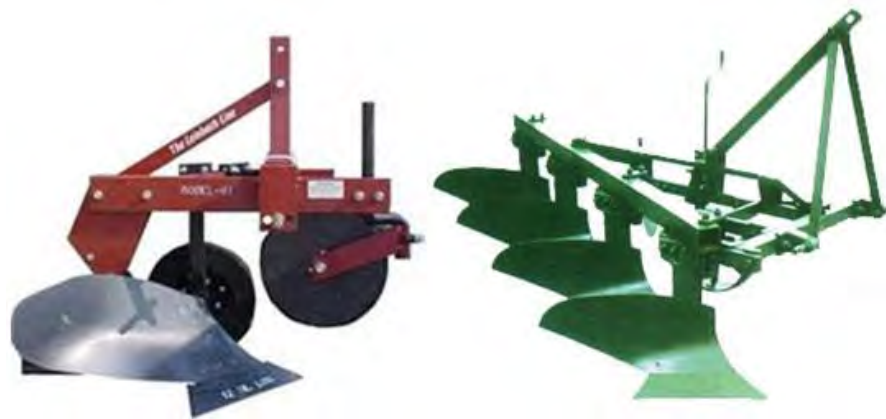
Gambar 17. Bajak Singkal satu arah
