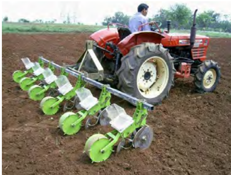
Gambar 28. Alat Penanam Sistem Baris Lebar
