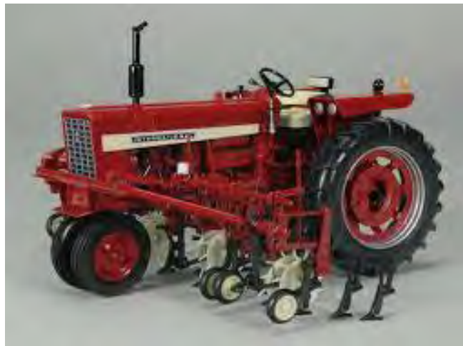
Gambar 42. Kultivator yang dipasang di bagian tengah
