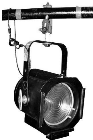
Gambar 26. Kawat baja untuk membantu menahan lampu
