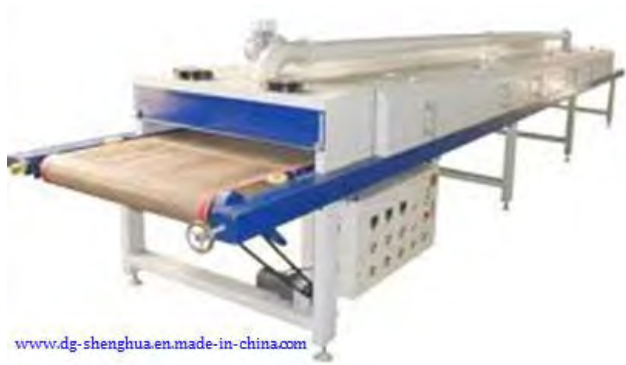
Gambar 35. Contoh pengering terowongan ( tunnel drier ).
