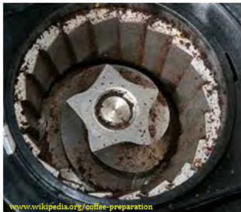
Gambar 12. Bagian dalam burr mill .
