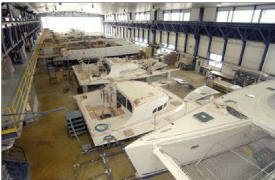
Gbr 4.95 dok/galangan Pembuatan Kapal Fiberglass
