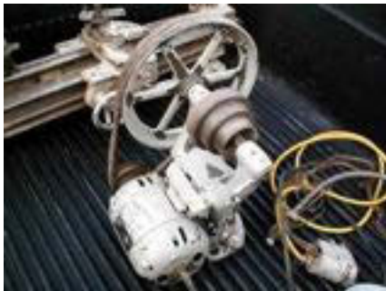
Gbr. Pemasangan V Belt
