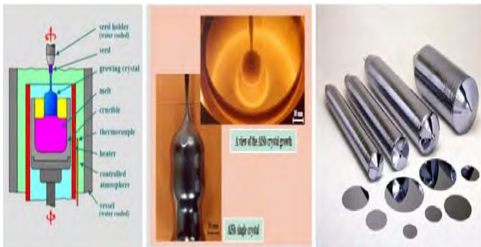
Gambar 2: Metoda Penumbuhan Kristal Mono Czochralski dan Produk Ingot
