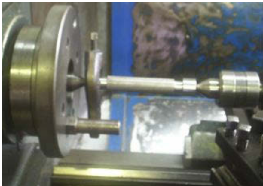
Gambar 2.32 Pembubutan diantara Dua Center
