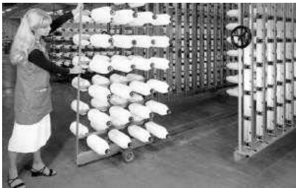
Gambar 12. Bentuk dan skema creel
