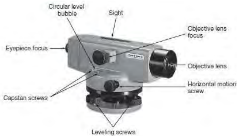
Gambar 1.3. Bagian-bagian umum dari pesawat sipat datar
