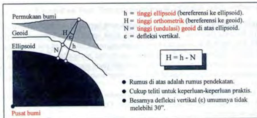
Gambar 4.20. Transformasi tinggi ellipsoid ke tinggi orthometrik
