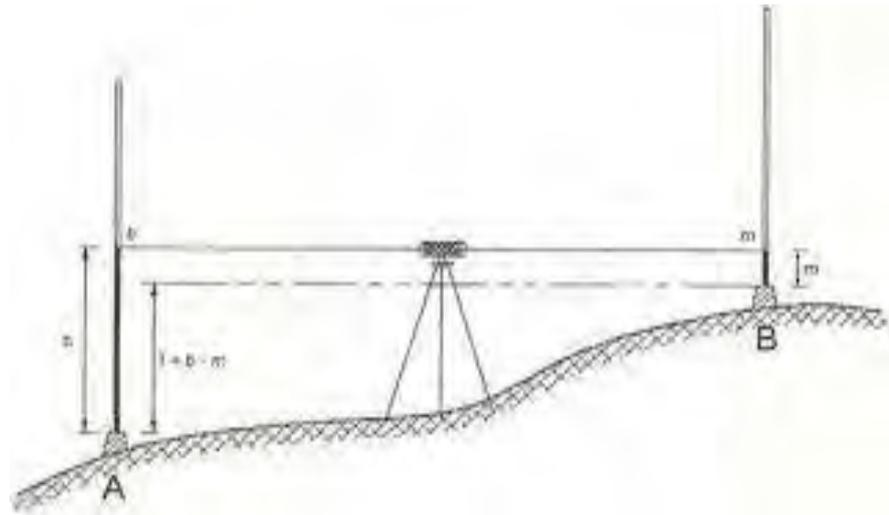
Gambar 2.12. Mengukur Beda tinggi dengan Sipat Datar
