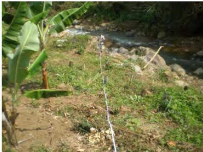
Gambar 7.2. Pengukuran Head menggunakan meteran
