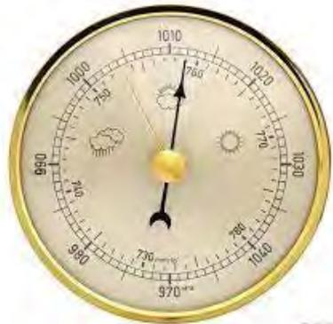
Gambar 2.3 Barometer aneroid (hampa udara)
