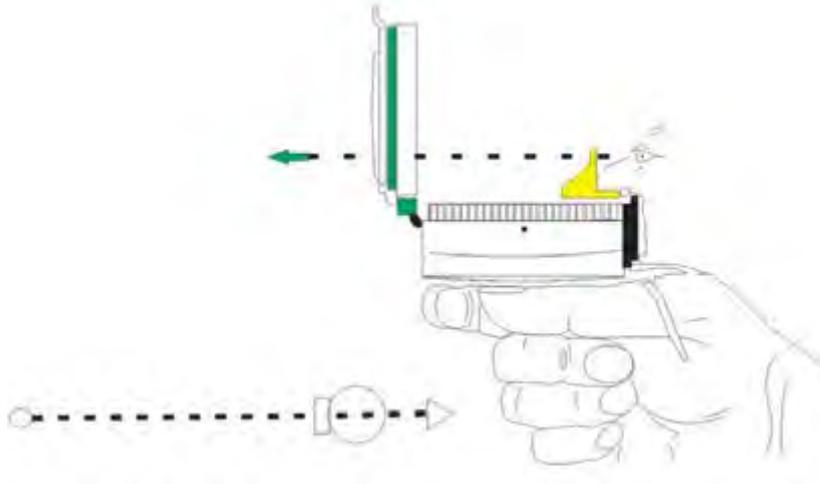
Gambar 2.3 Cara menggunakan kompas dengan benar
