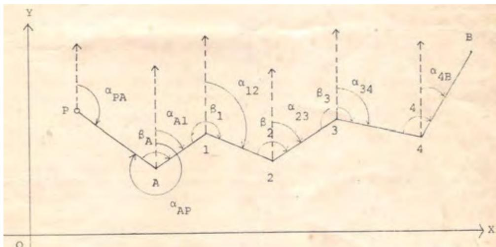
Gambar 3.7. Prinsip dasar Hitungan Sudut Jurusan Sisi Poligon
