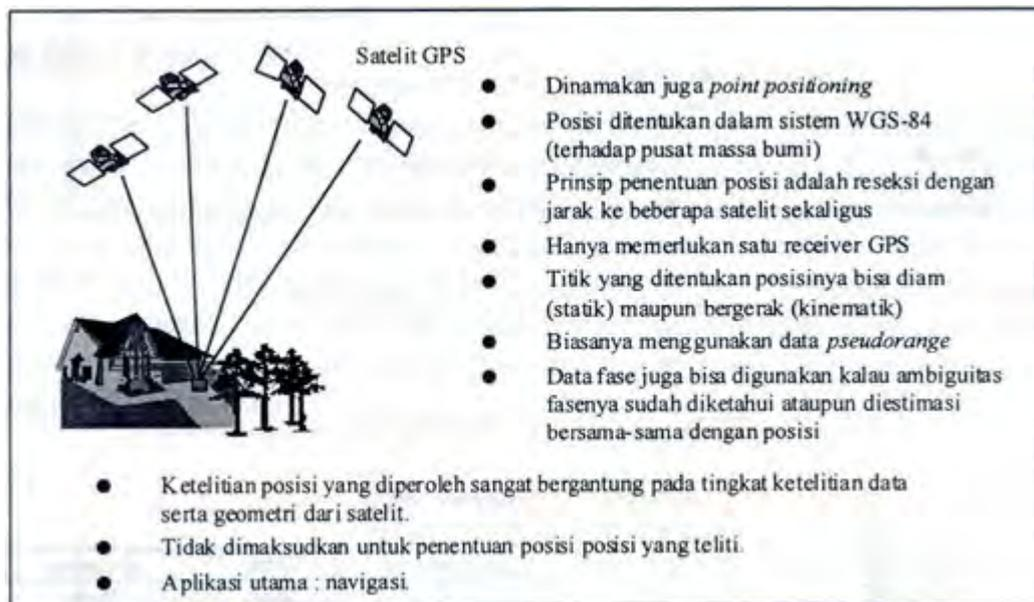
Gambar 4.10. Metode Penentuan posisi secara absolut
