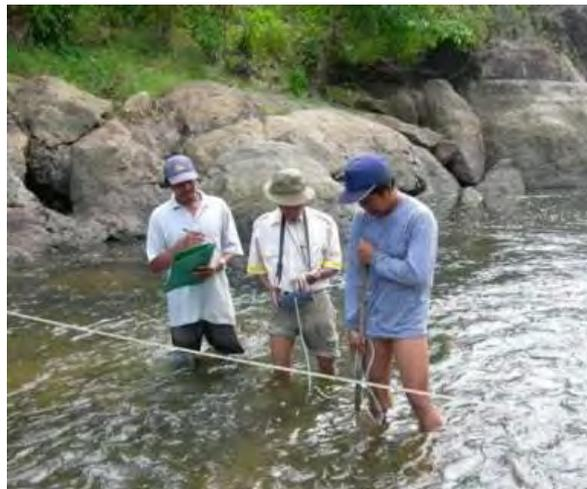
Gambar 7.4 Pelaksanaan pengukuran debit air menggunakan current meter di lapangan
