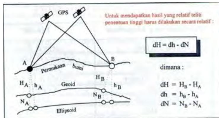
Gambar 4.21. Penentuan tinggi secara diferensial
