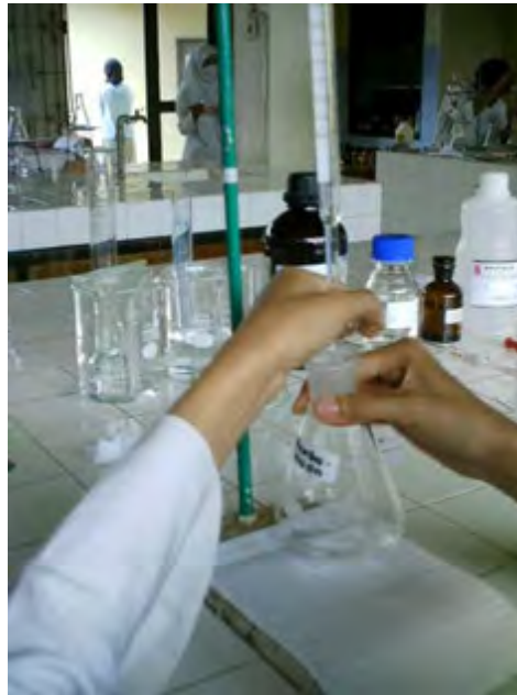
Gambar 32. Pengukuran kadar oksigen terlarut dengan cara titrasi
