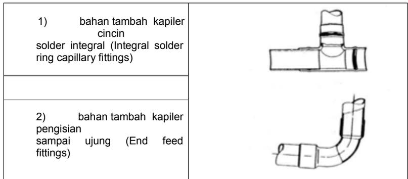
Gambar 1.16. Aksi Kapiler pada sambungan
