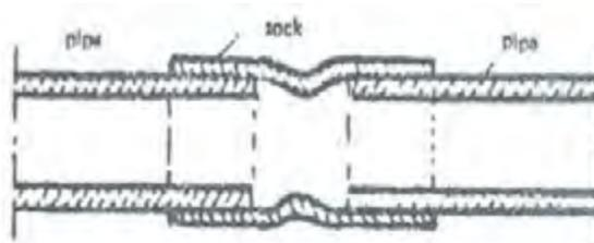
Gambar1.7. Gambar detail Sambungan soket
