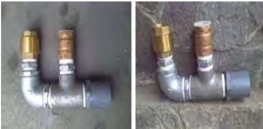
Tipe sambungan cabang dapat pula ditentukan pada spesifikasi yg telah dibuat sebelum mendesain atau dapat pula dihitung berdasarkan perhitungan kekuatan, kebutuhan, dengan tidak melupakan faktor efektifitasnya. Sambungan cabang itu sendiri merupakan
