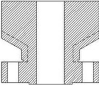
Jenis flange ini biasanya digunakan pada noozel di pressure vessel dan jarang digunakan pada pipa.
