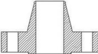
Flange jenis ini cocok digunakan untuk tekanan tinggi, temperatur ekstrim, shear impact maupun getaran tinggi, Lebih lanjut, konfigurasi ini tidak menimbulkan gangguan pada aliran.
