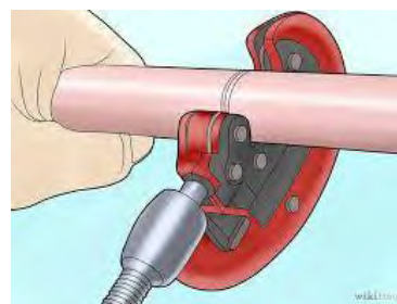
Gambar 4.22 cara menempatkan pipa pada rol
