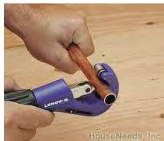
Gambar 4.22 cara menempatkan pipa pada rol
