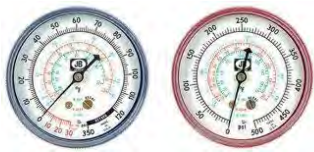
Gambar1. 8 Skala pada Compound dan Pressure Gauge
