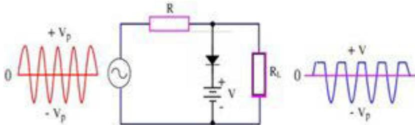
Pada gambar diatas, menunjukkan clipper dibias. Agar dioda dapat konduksi tegangan, input harus lebih besar dari pada  $+V$ . Ketika  $V_{in}$  lebih besar daripada  $+V$  dioda berlaku seperti saklar tertutup dan tegangan output sama dengan  $+V$  dan tegangan output tetap pada  $+V$  selama tegangan input melebihi  $+V$ . Ketika tegangan input kurang dari  $+V$  dioda terbuka dan rangkaian kembali pada pembagi tegangan.
