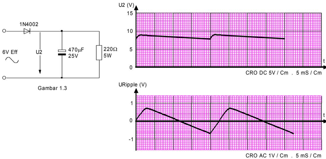
Gambar tegangan output setelah dipasang kapasitor dan bentuk tegangan ripple dengan beban  $R_L = 47\Omega$
