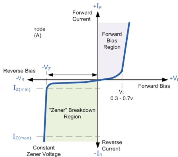
Gambar 3.9. grafik perubahan tegangan zener antara  $I_Z$  min dan  $I_Z$  max
