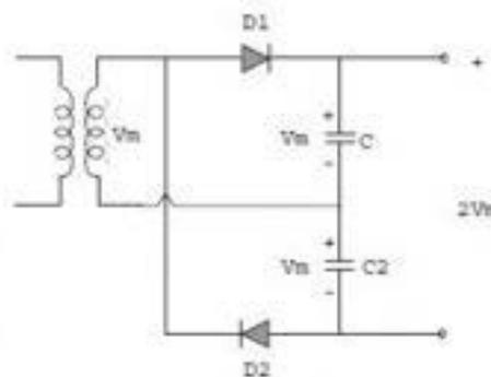
Selama siklus positif dari sekunder trafo dioda D1 menghantar dan C1 mengisi tegangan hingga  $V_m$ , sedangkan dioda D2 tidak menghantar (gambar prinsip kerja 1). Selama siklus negatif dioda D2 menghantar dan C2 mengisi tegangan hingga  $V_m$ , sedangkan dioda D1 tidak menghantar (gambar prinsip kerja 1). Tegangan puncak inverse (PIV) untuk setiap dioda adalah  $2V_m$ . Berikut gambar prinsip kerja rangkaian pelipat tegangan dua kali gelombang penuh.
