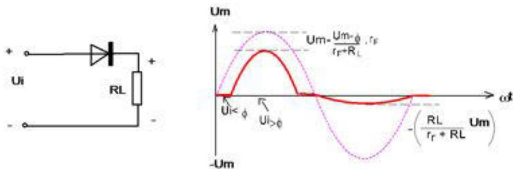
Gambar 2.3 Dioda sebagai penyearah gelombang sinus
