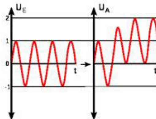
Rangkaian ini berfungsi untuk mendorong sinyal masukan pada suatu level tegangan DC tertentu.
