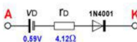
Gambar 1.4. Rangkaian pengganti dinamis dioda
