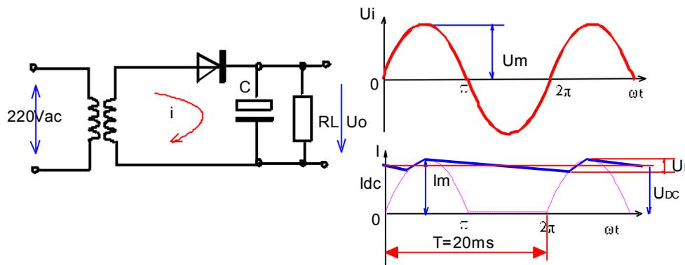
Gambar 2.7 Penyearah Transformator CT dengan Filter
