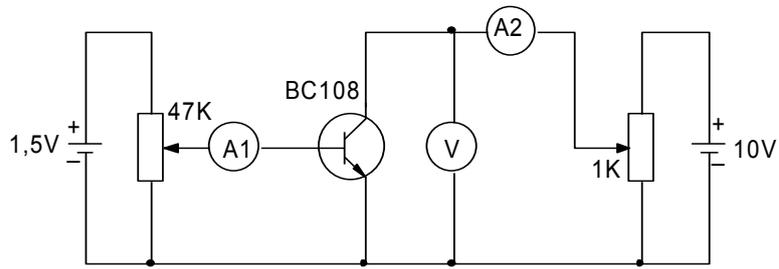
Gambar 1 mencari hubungan arus IB dan IC
