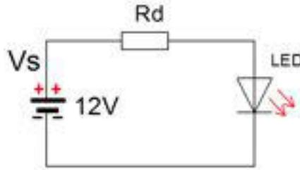
Gambar 4.5 Lampu LED dengan  $R_d$  yang diseri
