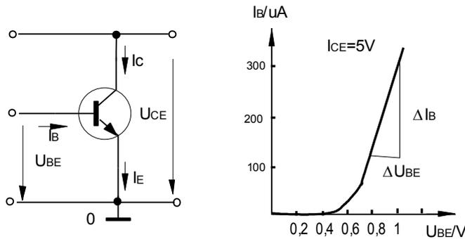
Gb.5.7 karakteristik input pada transistor NPN
