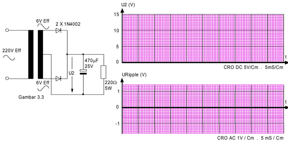
Pengamatan hasil penyearahan yang telah di berikan C sebagai filter dan pengamatan tegangan Ripple besar C 470 $\mu$ F dan RL 47 $\Omega$  yang terbaca pada CRO
