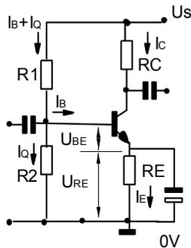
Gambar 6.12. susunan pembagian arus dan tegangan
