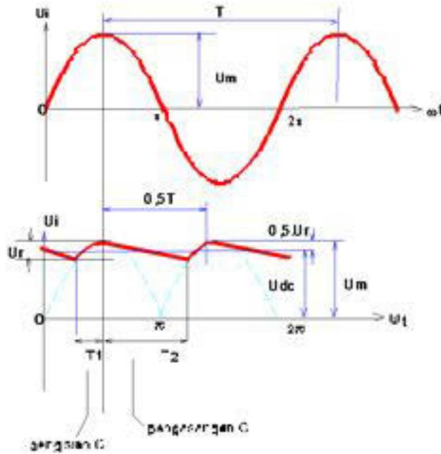
Dapat meratakan tegangan, memperkecil tegangan ripple
