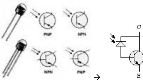
Gambar 5.4.11 Bentuk simbol dan Prinsip kerja Phototransistor
