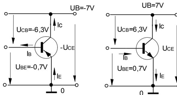
Gb.5.6 tegangan bias pada transistor NPN & PNP
