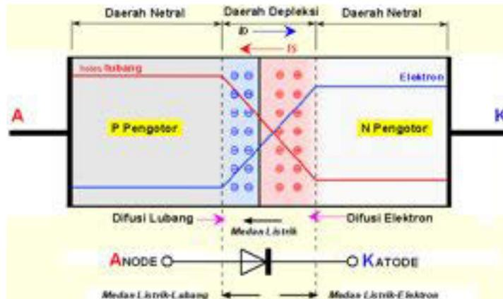
Gambar 2.100 Simbol dan konstruksi diode persambungan-PN
