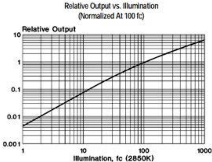
Gambar 5.4.8 Kurva hubungan antara Output dan Iluminasi
