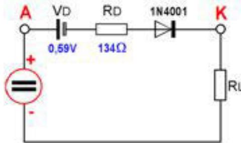
Gambar 1.6. Rangkaian dioda statis dengan beban  $R_L$
