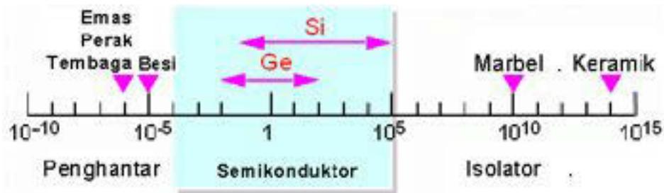
Gambar 2.85. Karakteristik Penghantar (Conductor), Semikonduktor (Semiconductor) dan Isolator (Insulator)
