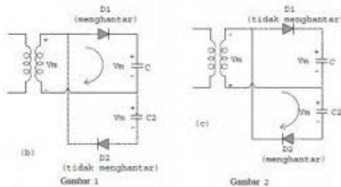
Jika tidak ada beban, maka tegangan pada ujung C1 dan C2 adalah  $2 V_m$ . Jika beban dipasang pada output, maka bentuk gelombang pada ujung C1 dan C2 adalah seperti halnya pada kapasitor yang diumpankan dari penyearah gelombang penuh. Perbedaannya adalah bahwa pada rangkaian pelipat tegangan ini C1 dan C2 berhubungan secara seri, sehingga nilainya lebih kecil dari masing-masing C.
