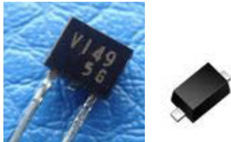
*Gambar 4.11 Dioda varactor benda rielnnya*
