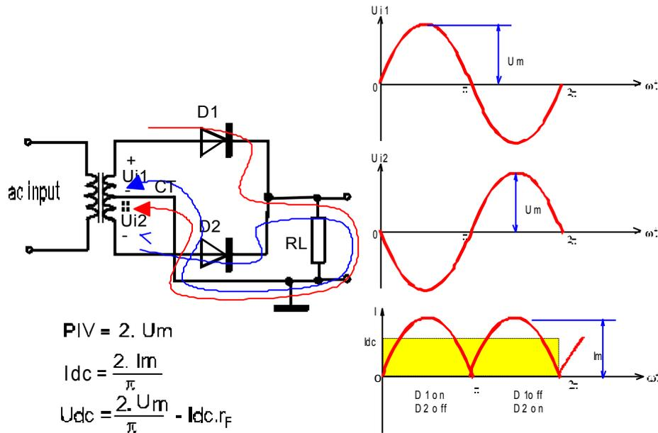
Gambar 2.7 Penyearah gelombang penuh dengan dua buah dioda
