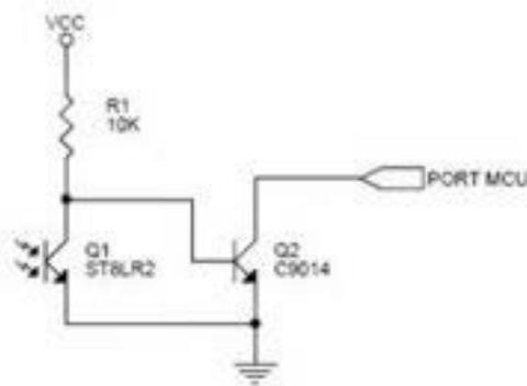
Gambar 5.4.12. Aplikasi Phototransistor
