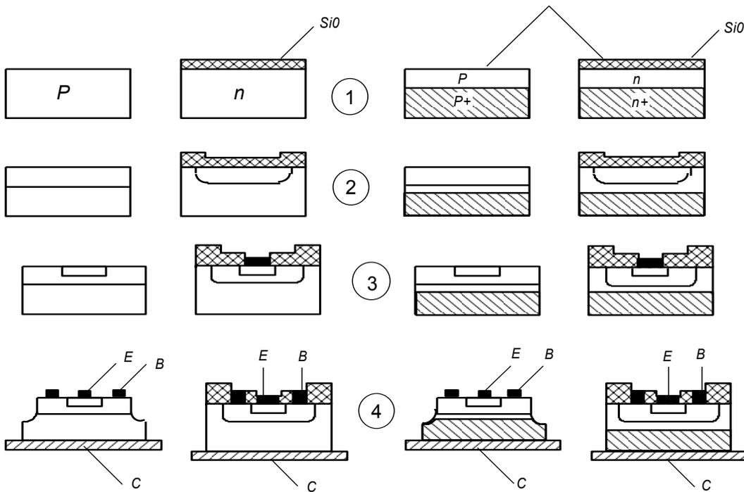
Gambar 5.2. Contoh Langkah proses pembuatan Transistor - epitaksial planar
