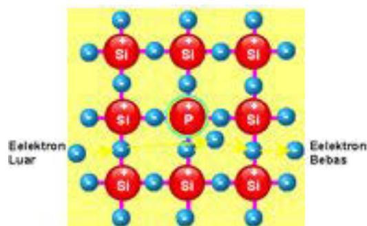
Gambar 2.98 Struktur dua dimensi kristal silikon dengan pengotor phosphor
