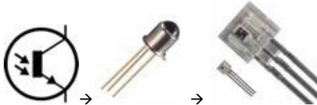
Phototransistor merupakan transistor yang dirancang untuk menangkap cahaya dan dirakit dalam sebuah kemasan transparan. Kepekaan phototransistor jauh lebih baik daripada photodiode karena phototransistor telah memiliki penguat terintegrasi. Cahaya yang diterima menimbulkan arus pada daerah basis dari phototransistor, dan menghasilkan penguatan arus mulai dari seratus hingga beberapa ribu kali.
