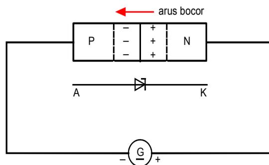
Gambar 3.5 Arus bocor dioda zener pada arah reverse
