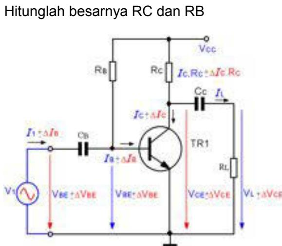
2. Sebuah penguat tunggal dengan Fix bias seperti tampak gambar dibawah ini, Transistor menggunakan BC547 dengan  $\beta$  Transistor 250, dan  $U_{BE}$  sebesar 0,6V diharapkan penguatan tegangan adalah 10x
