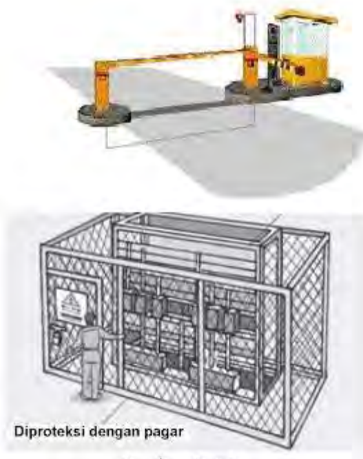
Gambar 3.24 Palang dan pagar pembatas area kerja
