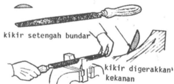
Gambar 6.68 Kikir setengah bulat untuk mengikir lubang bulat, alur cekung dan radius-dalam
