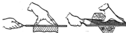
Gambar 6. 61. Pengikiran benda kerja tipis
