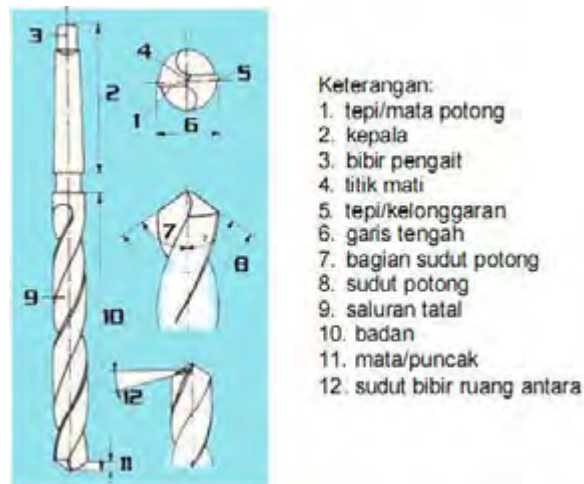
Gambar 6.82 Bagian-bagian mata bor
