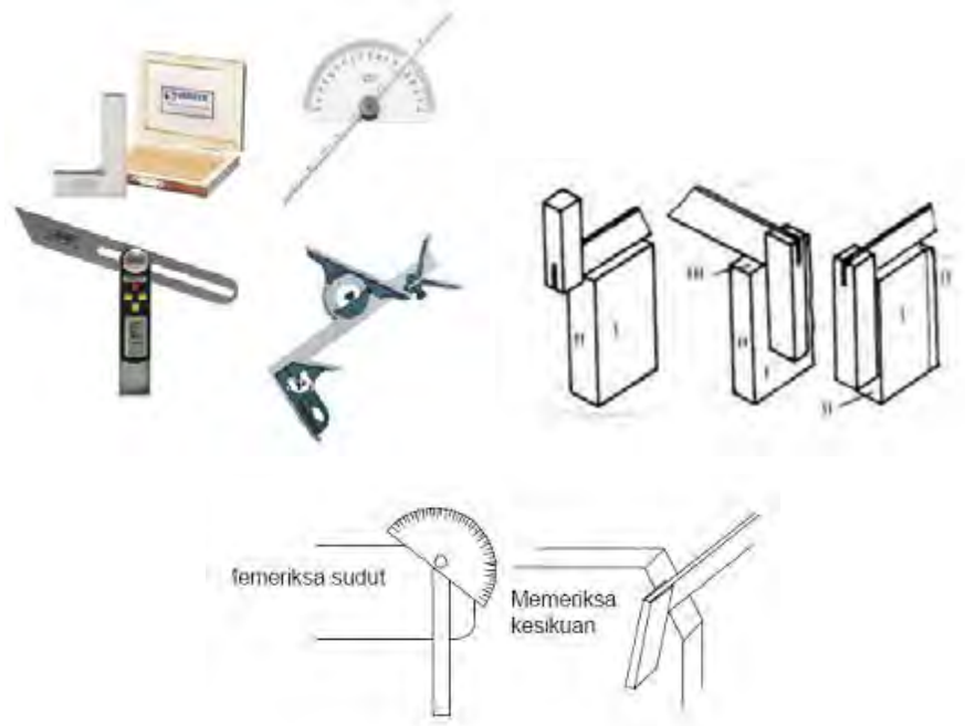
Gambar 6.81 Pemeriksaan kesikuan benda kerja
