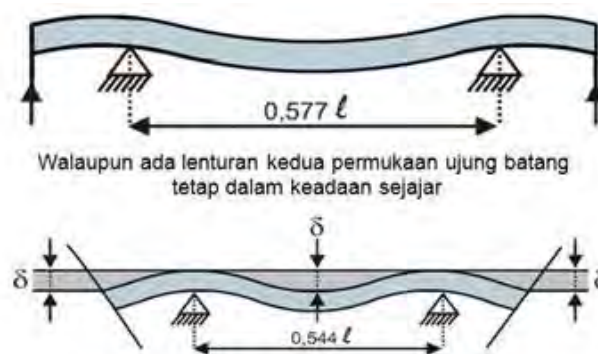
Gambar 2.15 Kesalahan Pengukuran Karena Benda Ukur
