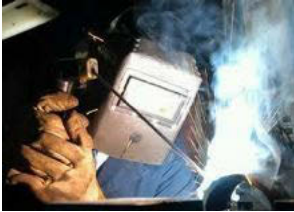
Gambar Proses pengelasan posisi bawah tangan
