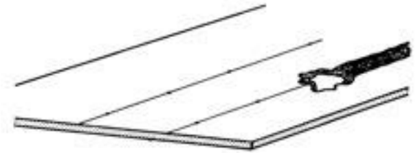
Kecepatan las terlalu lambat Alur las cacat
