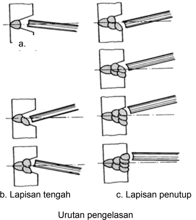
Untuk itu kemiringan batang elektroda bagi masing-masing alur las akan berbeda-beda.
