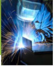
Elektroda langsung habis terpakai digunakan pada las busur listrik manual (*Shielded Metal Arc Welding – SMAW*), sedang pelindungnya dapat berupa gas yang berasal dari terbakarnya lapisan pelindung kimia (*coating*) elektroda tersebut atau berupa butir-butir (serbuk) zat pelindung oksidasi seperti yang digunakan pada las busur rendam (*Submerged Arc Welding – SAW*).
