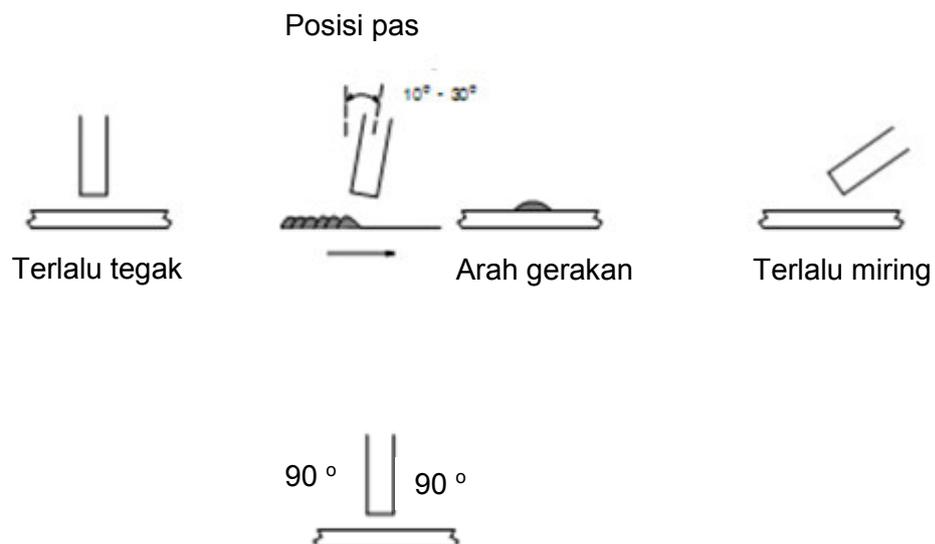
Gambar posisi elektroda untuk pengelasan
