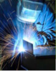
las yang menyusun menjadi alur las. Dan selubung yang mencair, melepaskan gas-gas pelindung yang melindungi tetesan-tetesan bahan tambah di dalam cairan las dari pengaruh oksidasi udara, terutama zat asam ( $O_2$ ) dan zat lemas ( $N_2$ )
