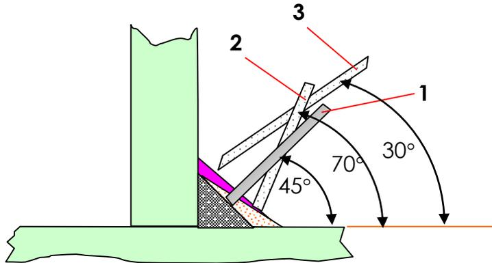
Gambar Penempatan bahan dan elektroda pada sambungan fillet T dua lapis tiga jalur
