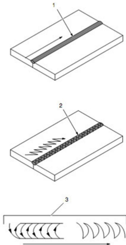
Untuk pengelasan pada celah sempit digunakan gerakan lurus sedang kan untuk alur yang lebar menggunakan gerakan elektroda dengan ayunan.
