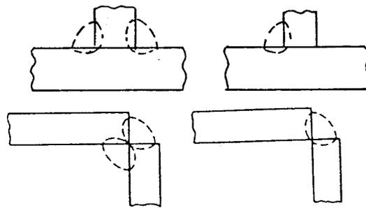
*Sambungan T ( T-Joint ) Sambungan Sudut ( Corner Joint )*
