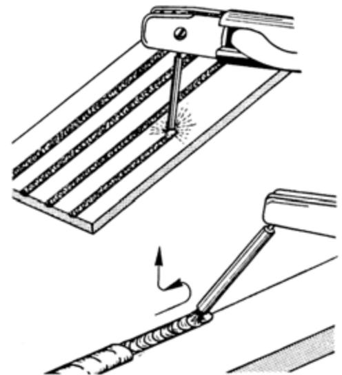
Sebelum melanjutkan pengelasan, terak pada ujung alur las harus dibersihkan lebih dahulu. Menyalakan elektroda yang baru, dimulai  $\pm 15$  mm dari ujung alur las yang terakhir,
