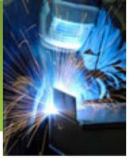
Apabila elektroda *low hydrogen* ini lembab, maka elektroda ini harus dikeringkan kembali pada temperatur antara 250° C sampai dengan 350° C selama 2 jam. Jangan melewati batas temperatur dan waktu maksimum yang diijinkan karena dapat menyebabkan perubahan kimia dalam salutannya yang akan berakibat perubahan secara tetap pada performansi elektroda tersebut.
