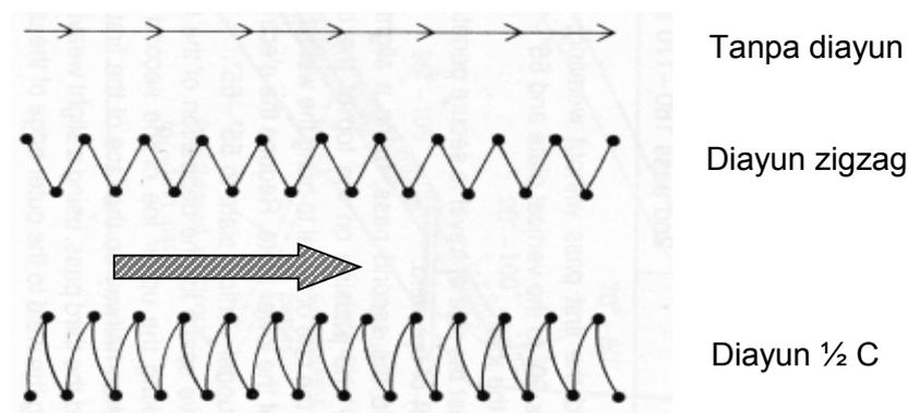
Gambar Arah dan Gerakan Elektroda posisi bawah tangan
