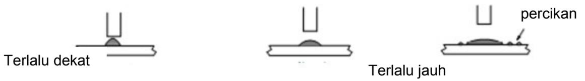
Gambar jarak elektroda terhadap benda kerja
