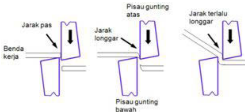
Gambar 4.8 Efek lebar ruang sayatan antara pisau gunting atas pisau gunting dan bawah
