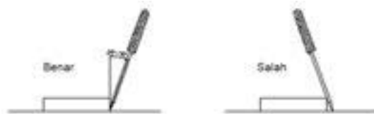
Gambar 4.8. Cara arah menggores benda kerja
