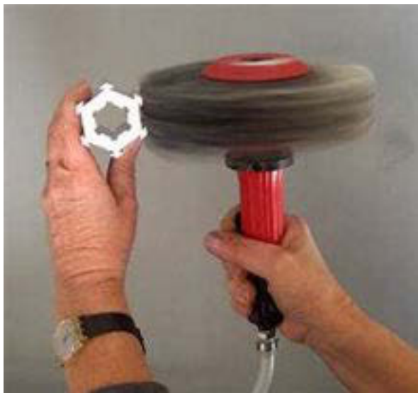
Gambar 6.24 Cara menggunakan gerinda
