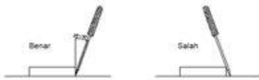
Gambar 3.8. Cara arah menggores benda kerja
