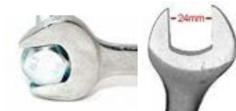
Gambar 4.22 Cara menggunakan kunci pas
