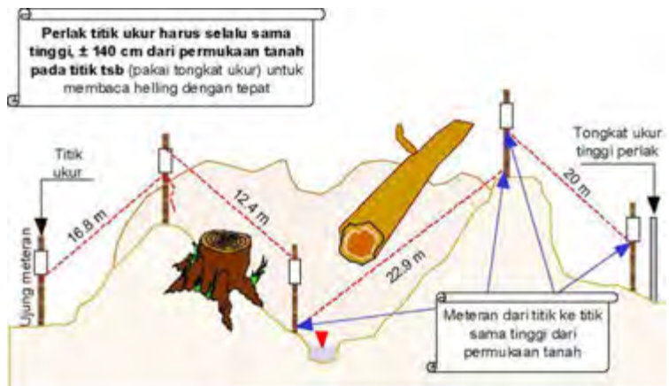
Gambar 9. Pengukuran jarak lapangan (Jaya,2011)
