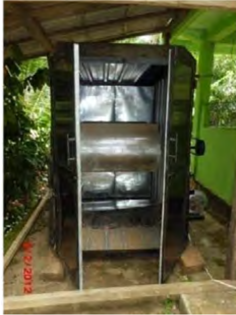
Gambar 12. Mesin Pengereng Tanaman menggunakan Listrik PLTMH
