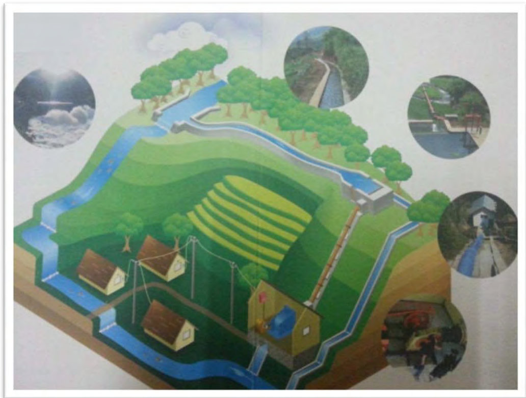
Gambar 2. Skema Sistem PLTMH
