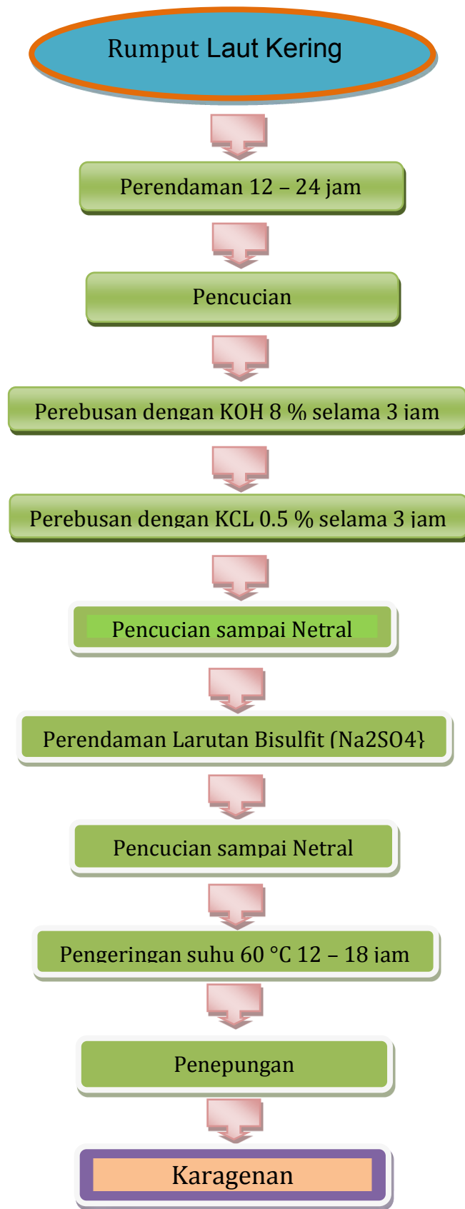
Gambar 45. Diagram alir pembuatan Karagenan.
