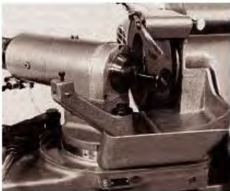
Gambar 3.150. Membentuk Sudut Katup
