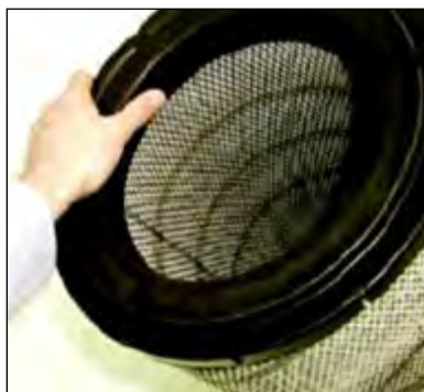
Gambar 1.11. Membersihkan Dry Element
