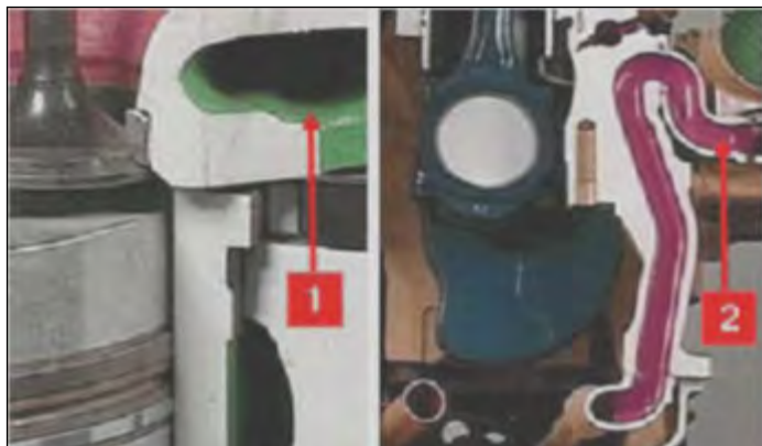
Gambar 3.57. Saluran air dan oli pada blok
