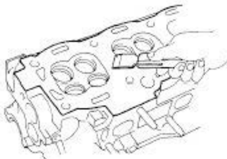
Gambar 3.132. Membersihkan dengan sekrap Kerataan Permukaan Cylinder head
