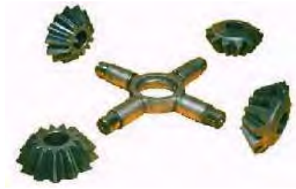
Gambar 9.14 Foto potongan dari rangkaian differential secara lengkap
