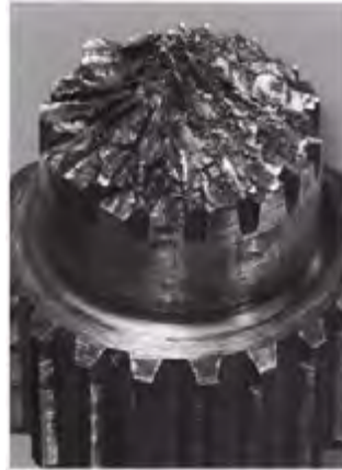
Gambar 11.4 – Kerusakan torque (torsi) yang berbentuk bintang
