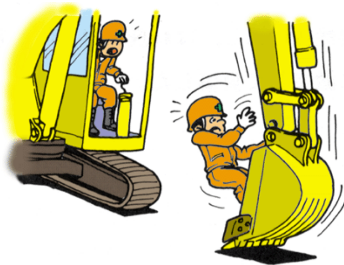
Gambar 2.2 Akibat dari sistem tidak dimatikan
