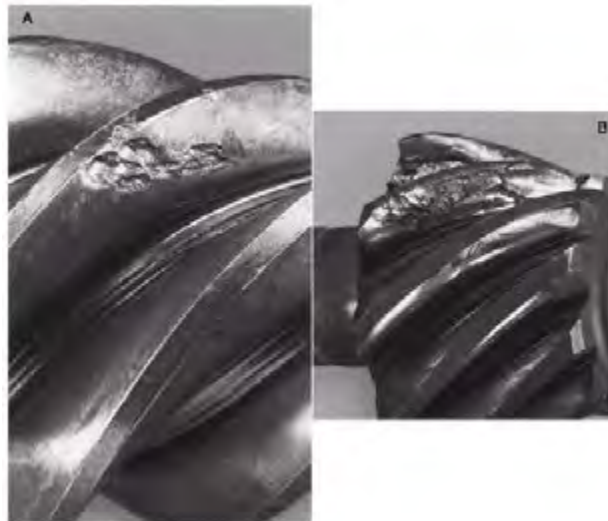
Gambar 11.3 – Pola kerusakan pada permukaan sebagai akibat wear (keausan): (A) retakan dan pecahan; dan (B) lubang dan pecahan
