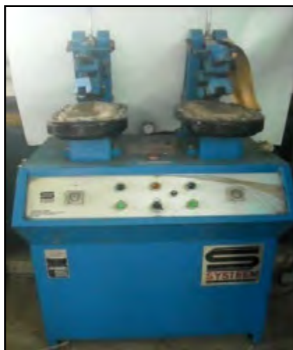
Gambar 3.21. Mesin press sepatu Sumber: Dokumen Studio Kulit P4TKSB Yogyakarta
