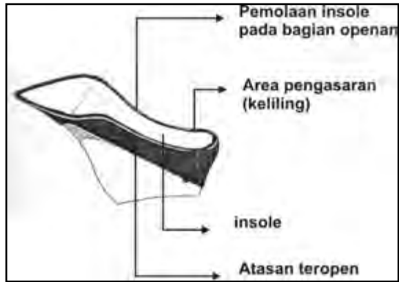
Gambar 3.72. Pengasaran pada hasil openan
