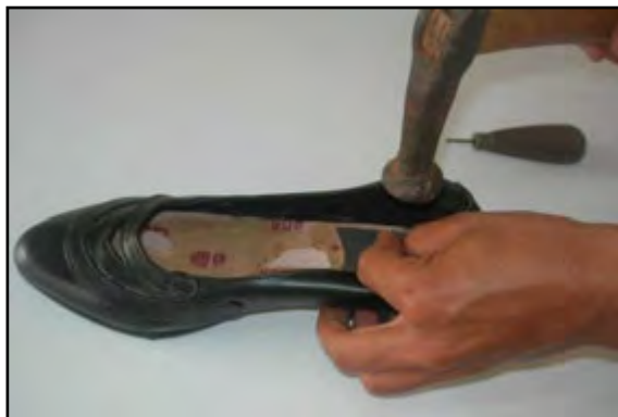
Gambar 3.88. Memaku hak sepatu
