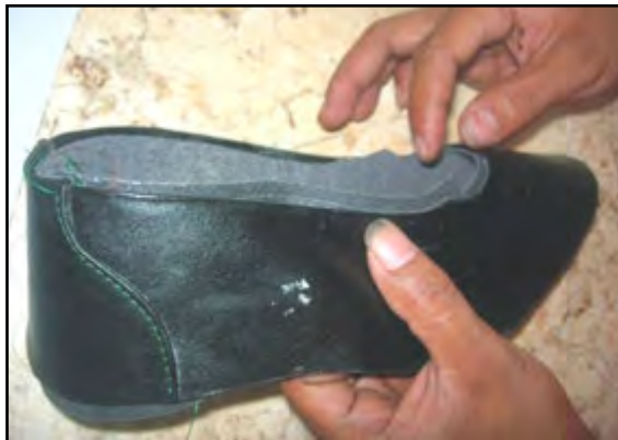
Gambar 3.52. Pemasangan lapis dalam
