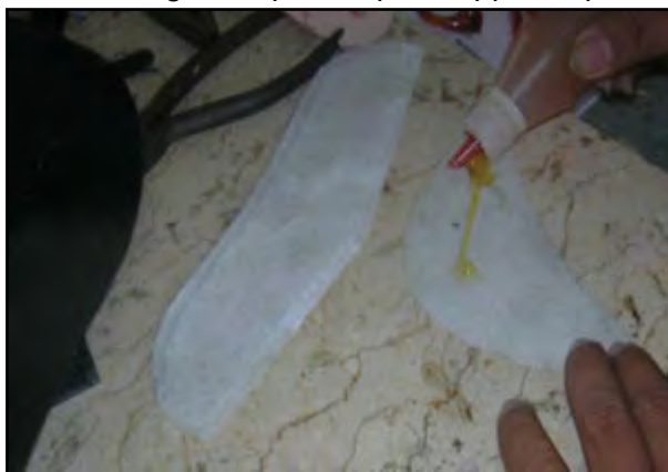
Gambar 5.57. Memberi lem pada pengeras
