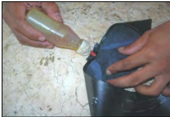
Gambar 3.48. Merakit back counter dengan vamp
