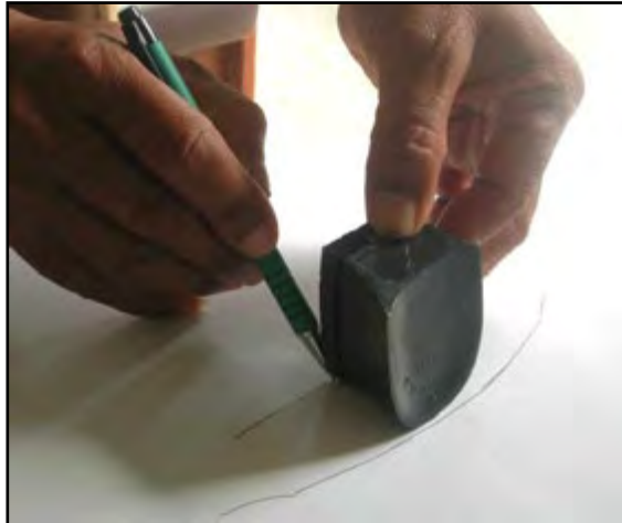
Gambar 3.77. Membuat pola lapisan hak dengan cara diputar
