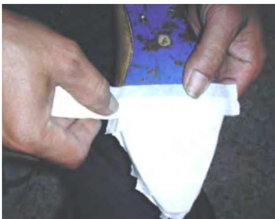
Gambar 3.56. Pemolaan telapak acuan dengan paper tape
