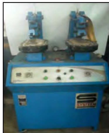
Gambar 1.27. Mesin press sepatu Sumber: Dokumen Studio Kulit P4TKSB Yogyakarta
