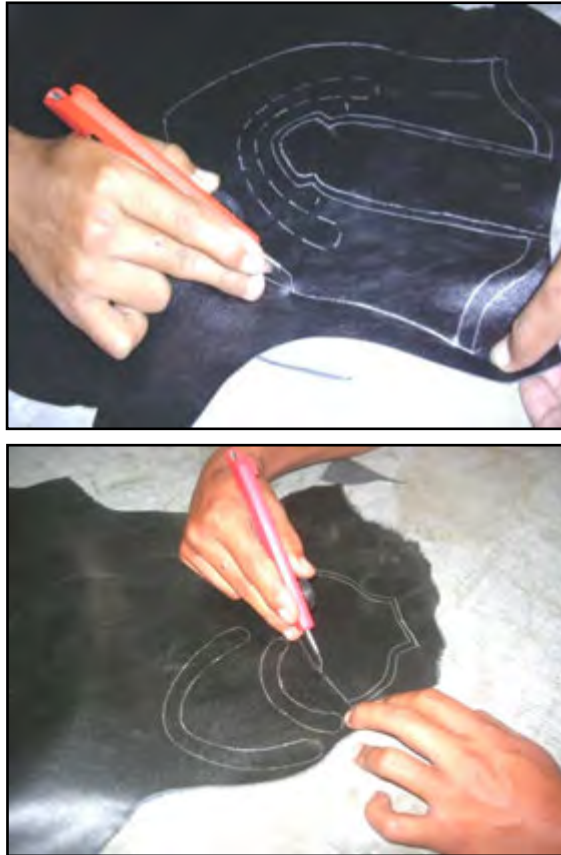
Gambar 3.40. Langkah pemotongan kulit dengan pisau
