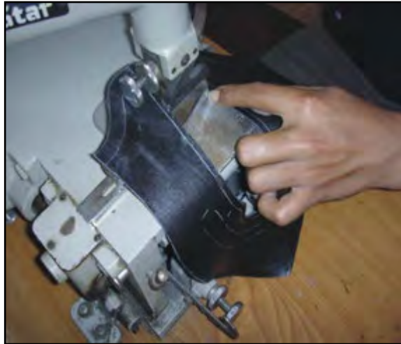
Gambar 3.41. Langkah penyesetan kulit dengan mesin seset
