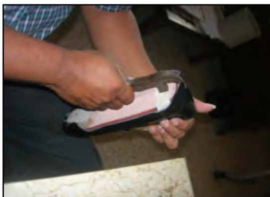
Gambar 5.63. Menarik pada bagian pangkal
