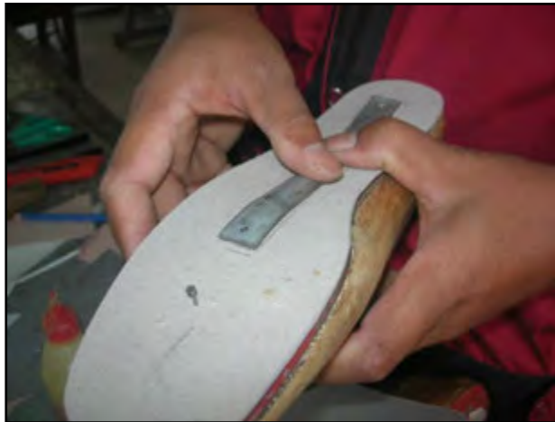
Gambar 5.49. Memasang in sole pada acuan
