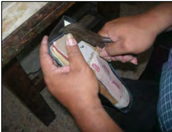
Gambar 5.59. Menarik pada bagian ujung
