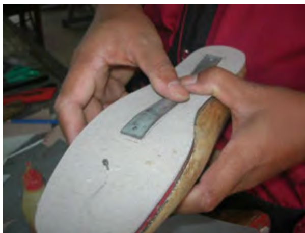
Gambar 3.68. Posisi penempelan tamsin pada telapak
