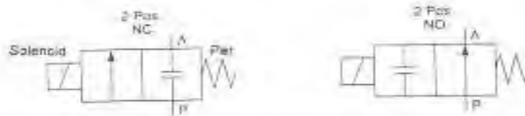
(c) Klep 2/2-jalan yang dioperasikan dengan solenoid
