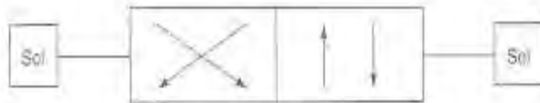
(e) Klep solenoid ganda 4/2 jalan dengan dua posisi dipertahankan (akan menjaga posisi tempat ia terakhir kali diberi daya)
