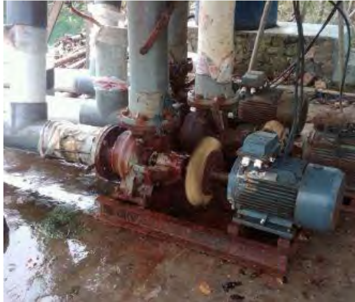
Gambar 28. Pompa axial untuk menyalurkan air tambak.
