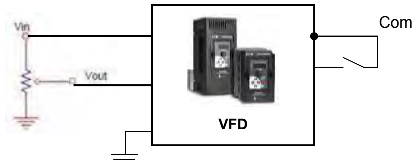
Gambar 4-9. Pengaturan Speed dengan Potensiometer pada VFD
