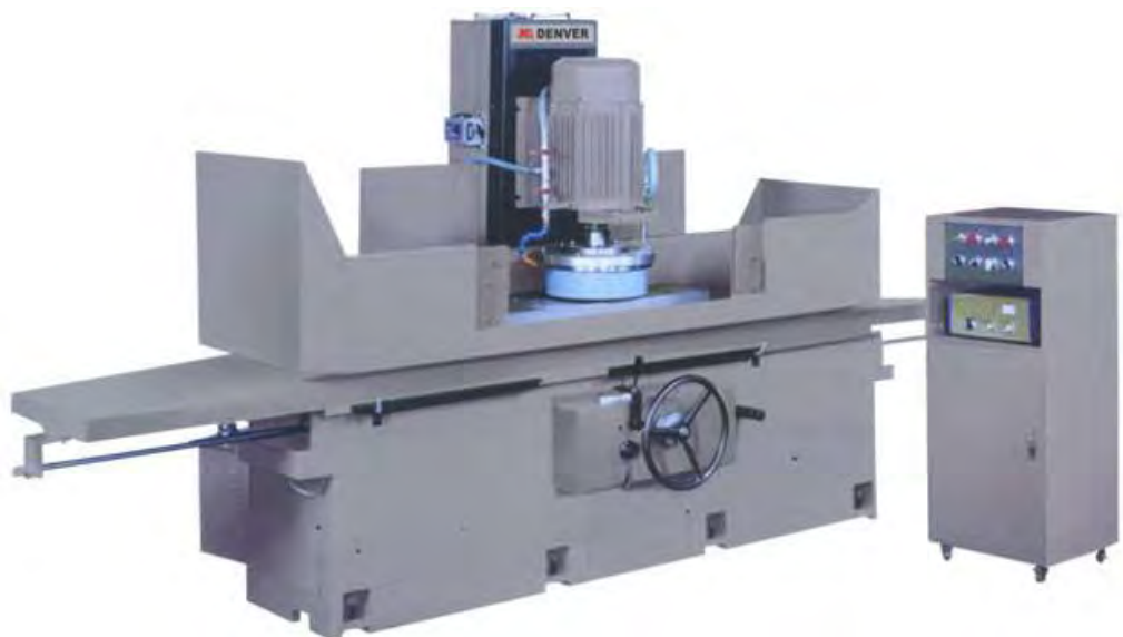
Gambar 1.8. Mesin Gerinda datar posisi spindel vertical dengan gerak meja bolak-balik
