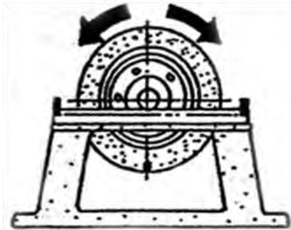
Gambar 2.57. Posisi terberat roda gerinda terletak pada bagian bawah (pusat gravitasi)
