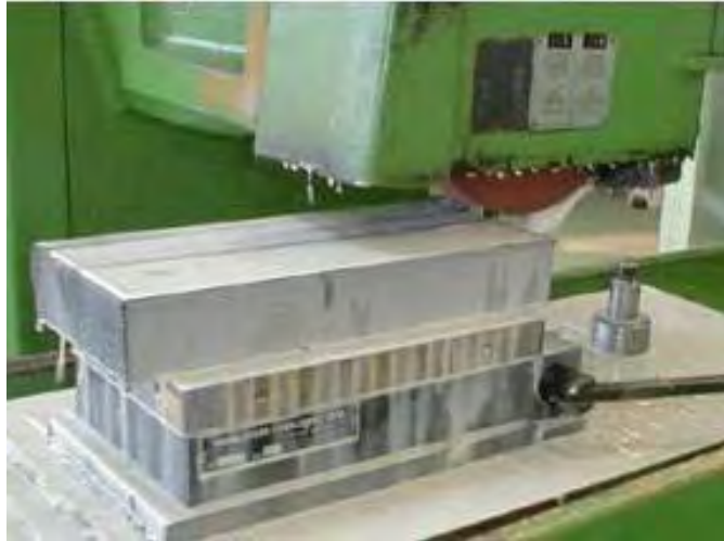
Gambar 4.14. Penggunaan media pendingin pada proses penggerindaan datar
