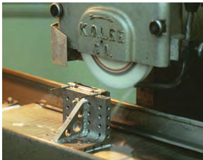
Gambar 4.12. Pengikatan benda kerja dengan balok penyiku
