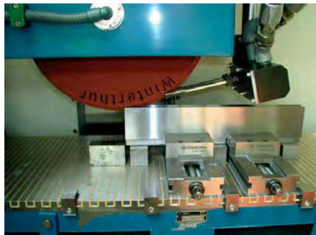
Gambar 4.9. Pengikatan benda kerja berukuran relatif panjang
