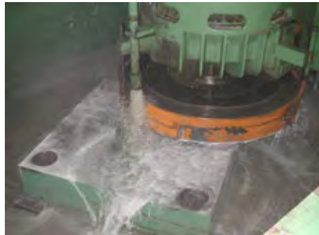
Gambar 1.7. Prinsip kerja mesin gerinda datar spindel vertikal dengan gerak meja bolak-balik
