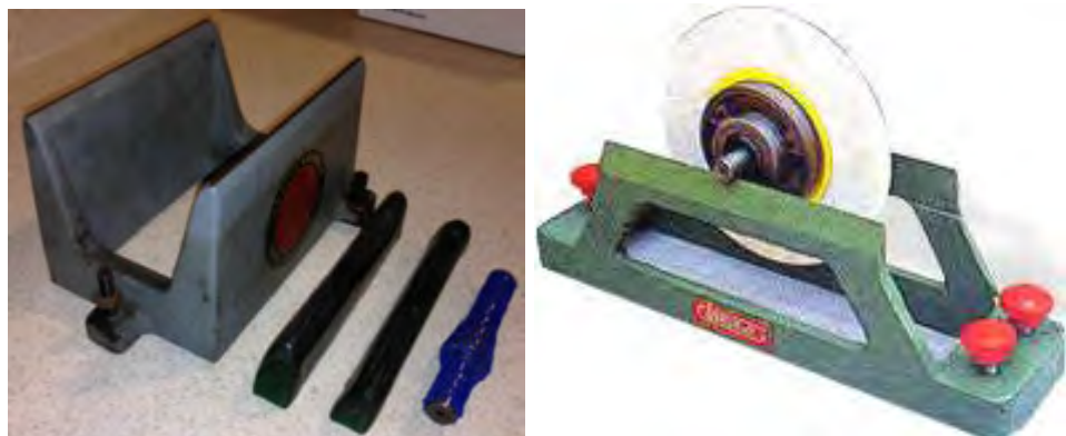
Gambar 1.45. Dudukan penyetimbang dengan batang pipih dan contoh penggunaannya
