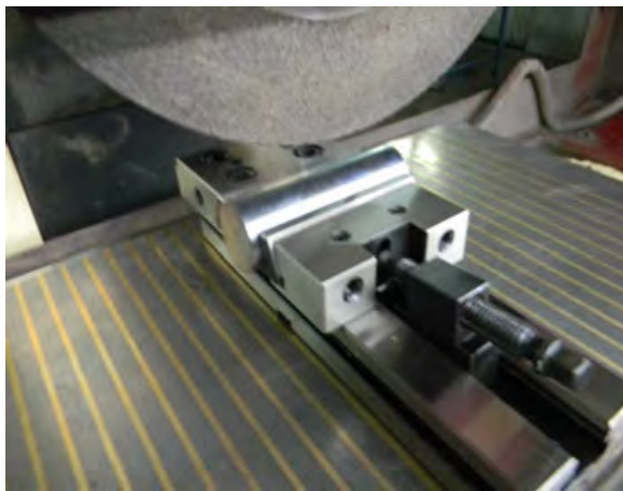
Gambar 4.10. Pengikatan benda kerja yang memiliki ukuran relatif pendek
