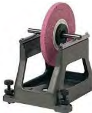
Gambar 2.56. Penempatan arbor pada dudukan peyetimbang
