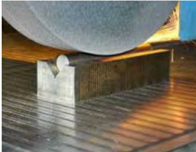
Gambar 4.11. Pengikatan benda kerja dengan balok penghantar magnet alur V
