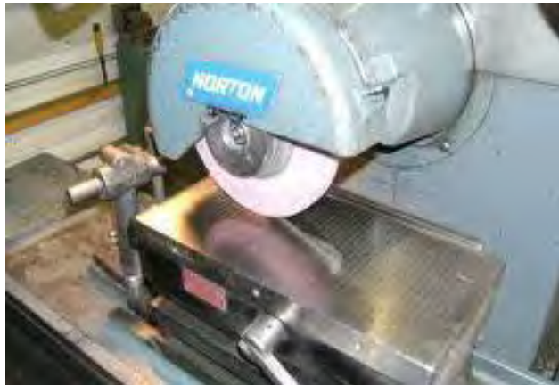
Gambar 4.3 . Penggerindaan permukaannya meja magnet
