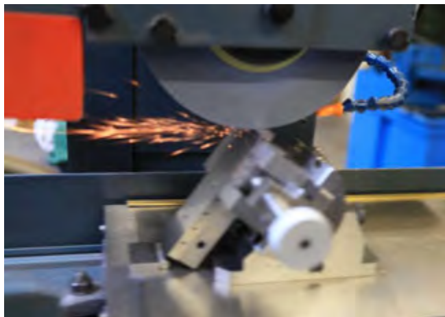
Gambar 4.18. Pengerindaan bidang miring dengan ragum sudut universal presisi
