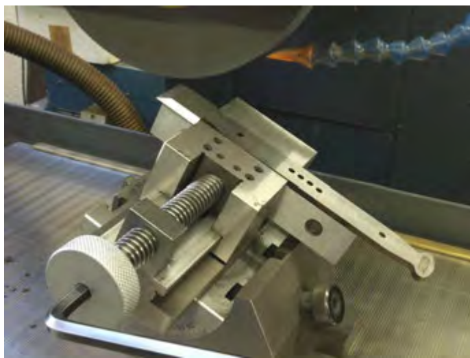
Gambar 4.13. Pengikatan benda kerja ragum sudut universal presisi
