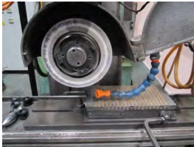
Gambar 4.14. Mengecek kondisi roda gerinda
