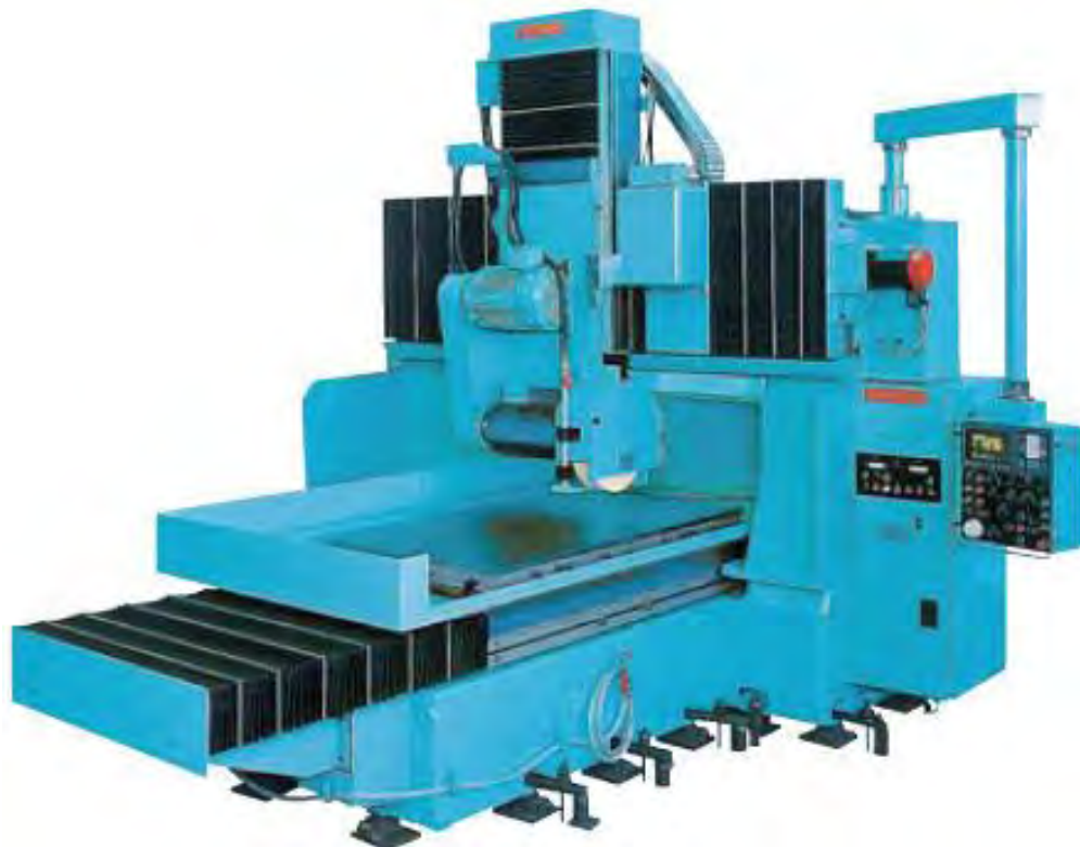
Gambar 1.4. Mesin gerinda datar spindel horizontal dengan gerak meja bolak-balik (kolom mesin dua buah)
