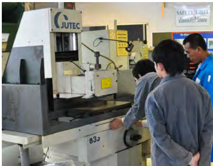
Gambar 4.25. Berkerumunan disekitar mesin gerinda datar yang sedang dioperasikan, tanpa menggunakan alat pelindung keselamatan kerja
