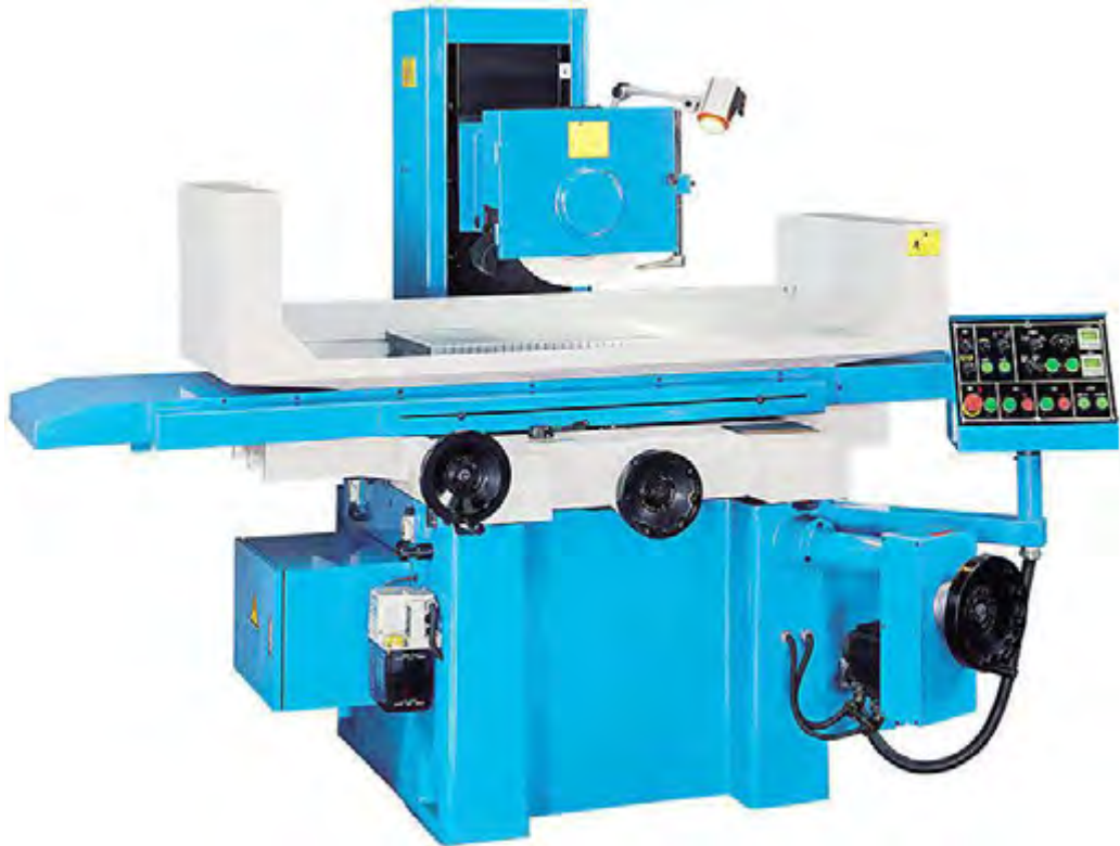
Gambar 1.3. Mesin gerinda datar spindel horizontal dengan gerak meja bolak-balik (kolom mesin satu buah)
