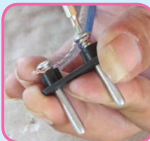
Sumber: Dokumen Kemdikbud Gambar 2.37 Kabel dan colokan jantan
