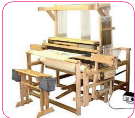
Alat tenun ATBM (Alat Tenun Bukan Mesin) untuk teknik tenun pada serat.
