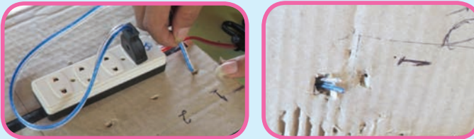
Sumber: Dokumen Kemdikbud Gambar 2.39 Colokan jantan di terminal 4 mata
