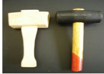
(Sumber: Dokumen Kemdikbud) Gambar 1.19 Palu terbuat dari bahan kayu yang berserat padat ulet dan keras
