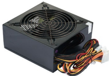
Gambar 1.1 Powersupply dan kabel-kabel untuk mengalirkan arus listrik ke komponen di dalam kotak CPU (Sumber: Dok. Penulis)
