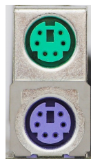
Gambar 1.2 Port PS/2. Port warna hijau (atas) digunakan untuk mouse dan warna ungu (bawah) untuk keyboard (Sumber: Dok. Penulis)
